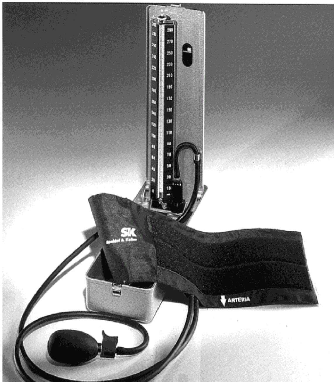
Slika 2: Fotografija tlakomjera za krvni tlak tipa MINIATUR 300 S
